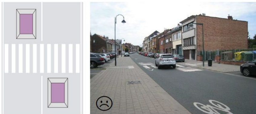
Figuur 6: Gevaar voor onaangepast gedrag bij rijbaankussens met zigzagdoorgang zonder fysieke scheiding [OCW 2020_1]
