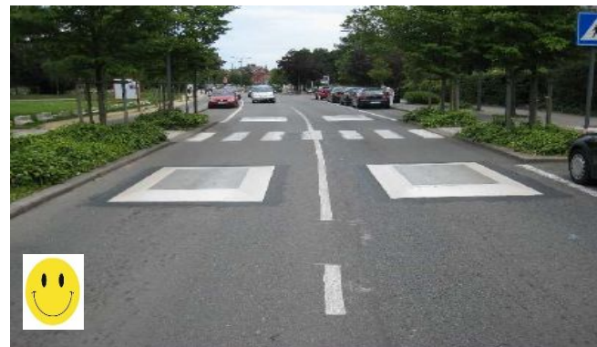
Figuur 7: Naast elkaar geplaatste rijbaankussens bij een oversteekplaats voor voetgangers op een rijbaan die tussen 6 en 7,2 m breed is [OCW 2020_1]
