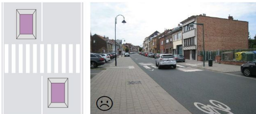
Figure 6: Risque de comportement inapproprié en présence de coussins en chicane sans séparation physique [CRR 2020_1]
