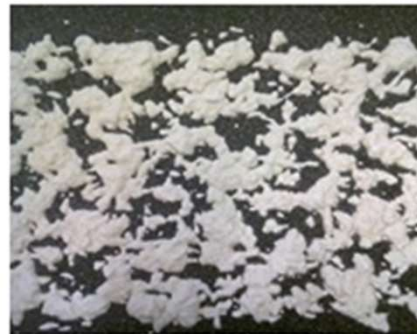
Geprofileerde wegmarkering (met verbeterde nachtzichtbaarheid bij regenweeren een nat wegdek) - spettermarkering
